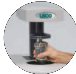
Obr. 3 – Umístění kalorimetrické bomby do přístroje
