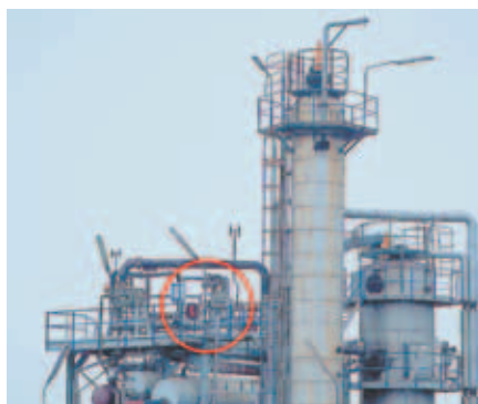
Obr. 4 – Horizontálně instalovaný Compabloc® s titanovými deskami pro kondenzaci par při vakuu v destilační věži společnosti Nynas Petroleum ve švédském Gothenburgu
