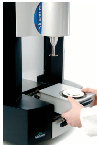
Obr. 3 – Jeden z plug and play modulů zajišťující řízení parametrů prostředí
