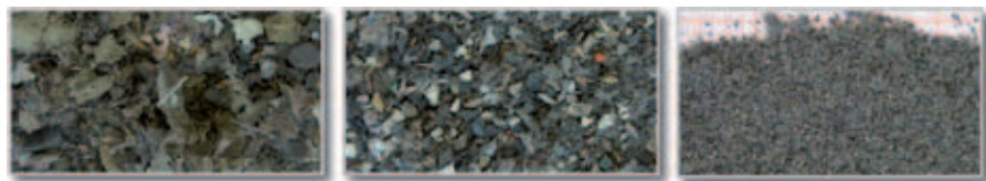
Obr. 2 – Sekundární paliva (zleva doprava): počáteční vzorek, po předběžném mletí v SM 300 a jemně pomletý vzorek
