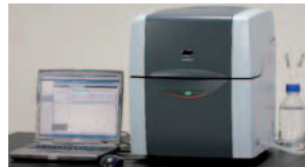
Obr. 7 – MultiNA – mikročipová elektroforéza pro RNA/DNA automatické analýzy
