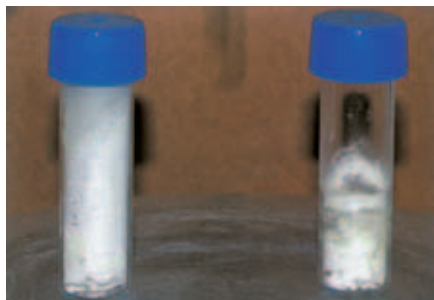
Obr. 6 – Výsledek postupu Solid-Phase Trapping – separované látky dostanete v čistém stavu
