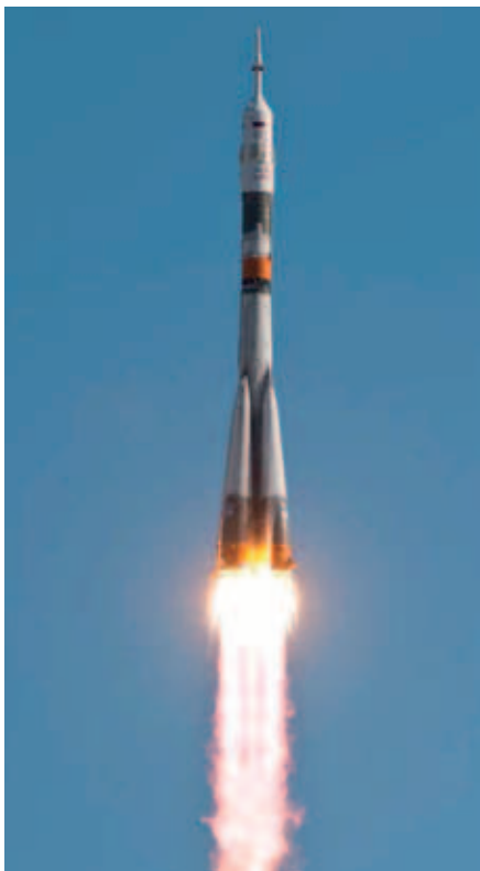
Obr. 1 – Vysoce koncentrovaný peroxid vodíku (82,5%) pohání turbočerpadla, která pumpují kerosen a kapalný kyslík do spalovacích trysek rakety (Foto Evonik)
