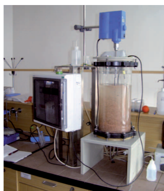
Obr. 1 – Laboratorní aparatura pro denitrifikaci Biotechnologií LentiKats
