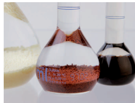
Obr. – Iontoměniče Lewatit odstraňují během úpravy vody škodlivé látky jako např. nikl nebo nitráty
