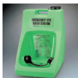
Obr. 6a – Tankové přenosné sprchy 22 nebo 60 l na stůl nebo na stěnu, pro výplach 5 resp. 15 minut. Výplach: gravitační, bez tlaku
