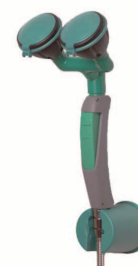
Obr. 4b – Oční flexibilní sprcha umístěná na stěně (možnost montáže i na stůl nebo pracovní desku), sklon 45 stupňů pro lepší polohu vzhledem k postiženému (i menšího vzrůstu), ale se dvěma hlavici (větší průtok, lepší omytí i obličej)
