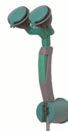
Obr. 4b – Oční flexibilní sprcha umístěná na stěně (možnost montáže i na stůl nebo pracovní desku), sklon 45 stupňů pro lepší polohu vzhledem k postiženému (i menšího vzrůstu), ale se dvěma hlavice (větší průtok, lepší omytí i obličej)
