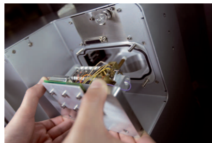
Obr. 2 – Vyjmutí iontového zdroje
