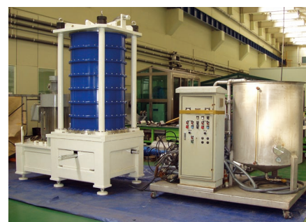
Obr. 2 – Modul technologie FMX s rozvaděčem a vyrovnávací nádrží
