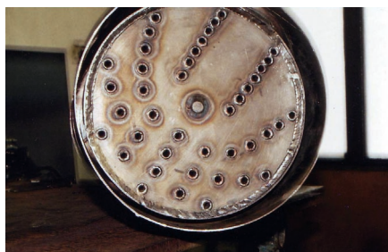
Obr. 3 – Trubkovnice vinutého výměníku
