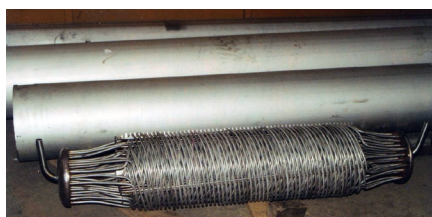
Obr. 2 – Vinutý výměník připravený pro moření a následnou expedici
