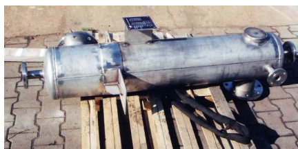
Obr. 2 – Vinutý výměník připravený pro moření a následnou expedici
