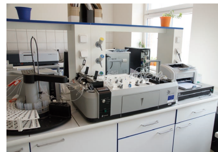
Obr. 3 – Průtokový analyzátor Skalar SAN-plus ke stanovení živin
