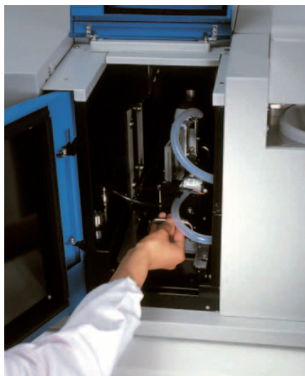
Obr. 2 – Kyvetový prostor přístroje Partica LA950 s velmi snadným přístupem a několika kyvetami na nosiči
