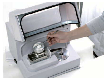
Obr. 3 – Konstrukce násypky vzorku pro suché měření přístroje PARTICA LA 950
