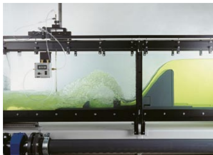
Obr. 4 – Přepadový jez s můstkem a měřením průtokové rychlosti
