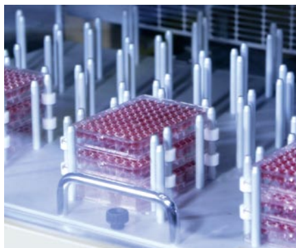
Obr. 1 – Mikrotitrační destičky v inkubované třepačce upravené až pro 999 RPM
