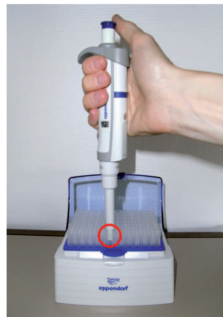
Obr. 3 – Nasazování špiček pipet Eppendorf Research® Plus
